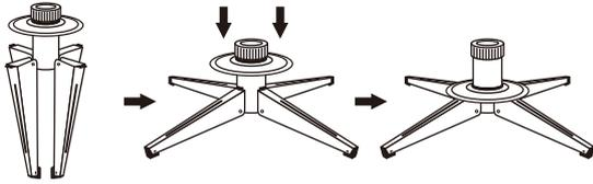
Dépliez les pieds et déposez le support sur une surface plane. Glissez ensuite le disque de blocage vers le bas jusqu'à ce qu'il se verrouille.
