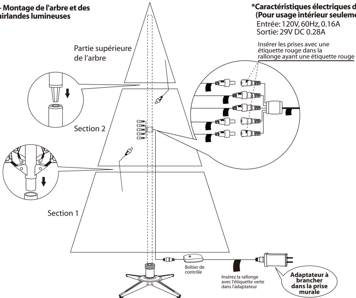
3. Chacune des sections de l'arbre est numérotée avec un autocollant. Veuillez repérer toutes les sections avant d'assembler l'arbre.
